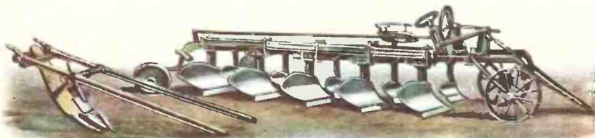
Пятикорпусный тракторный плуг. Слева для сравнения художник нарисовал соху.
