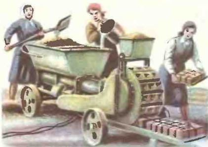
Машина изготавливает торфоперегнойные горшочки.
