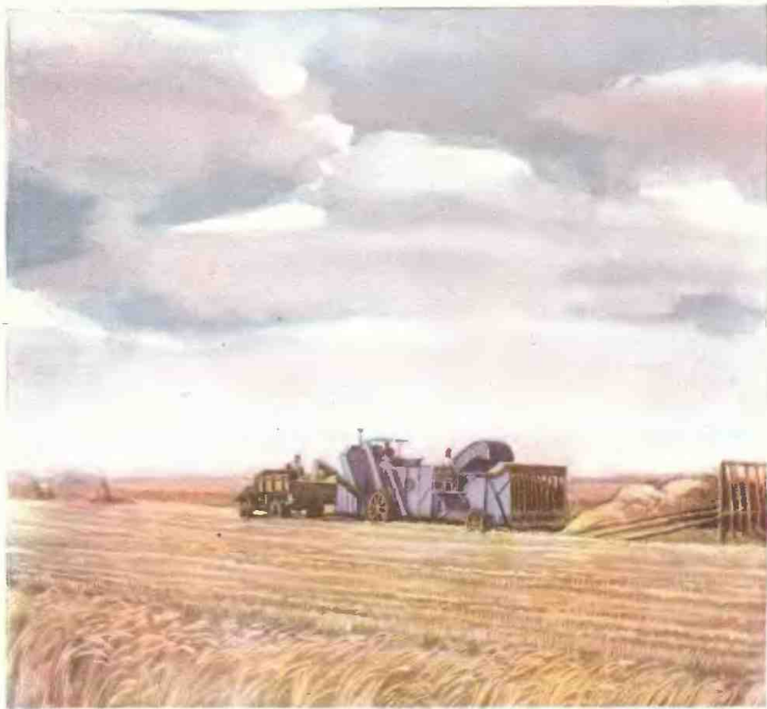
Уборка хлеба прицепным комбайном с копнителем и волокушей.
