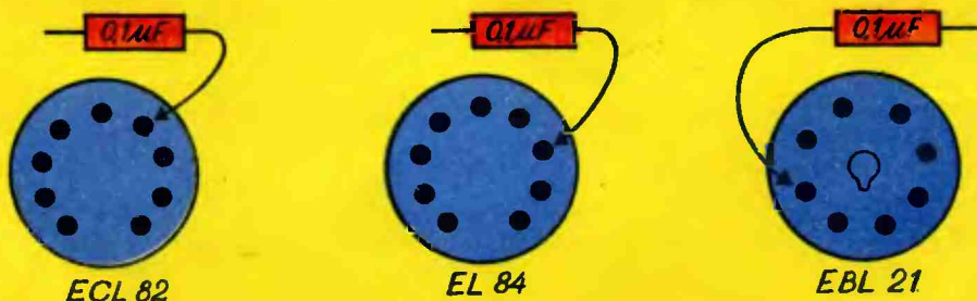
Рис. 4. Подключение магнитофона к выводам цоколей чаще всего встречающихся ламп усилителя низкой частоты (вид цоколя лампы снизу).
